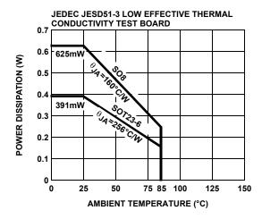
FIGURE 10. PACKAGE POWER DISSIPATION VS AMBIENT TEMPERATURE
