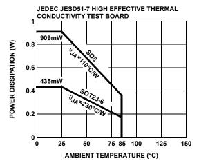
FIGURE 9. PACKAGE POWER DISSIPATION vs AMBIENT TEMPERATURE
